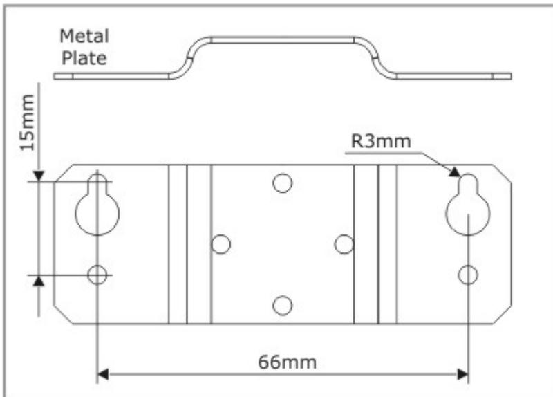
Attach the Metal plate to the DS100/DS202 as shown below.
